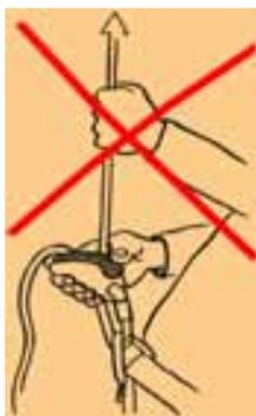
**ERRADO:** segurar a ponta do escalador e segurar o Gri-gri com alavanca. No susto, o segurador aperta a alavanca, liberando a corda, e aperta a mão na ponta do escalador, queimando-a.
