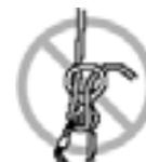
Um cuidado especial é necessário em relação ao posicionamento do Oito no mosquetão: se o anel menor do aparelho ficar em cima do gatilho, pode quebrá-lo e abrir o mosquetão, com conseqüências potencialmente fatais (a trava não impede isto!). Existem duas formas para evitar isto:
